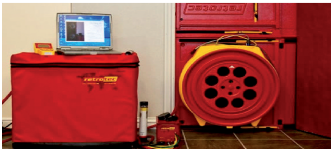
Figura 5 - Set-up per l'esecuzione di un Door Fan Integrity Test
